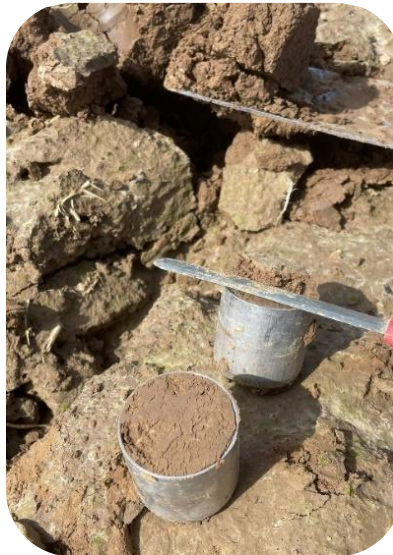
Figure 2. Prélèvement de mottes de volume normalisé pour le QuantiSlakeTest.
