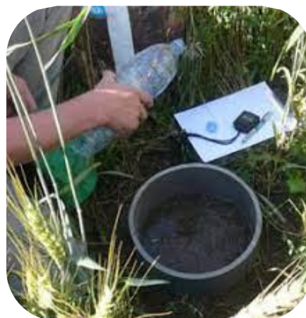
Figure 1. Test Beerkan permettant d'évaluer la capacité d'infiltration de l'eau dans le sol (Source : ITAB Asso).
