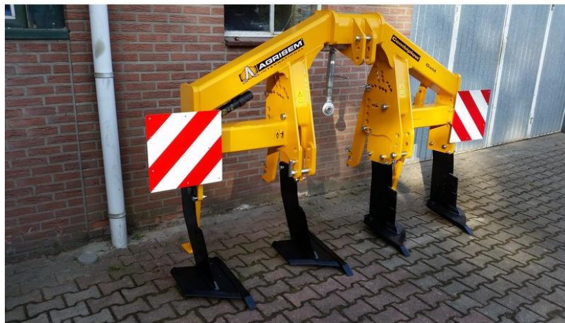
Figure 9 : Décompacteur Agrisem (largeur 3 m, 4 dents)
