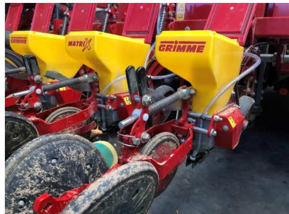
Figure 56: adaptation du semoir pour application d'extrait de compost (03/05/2023)
