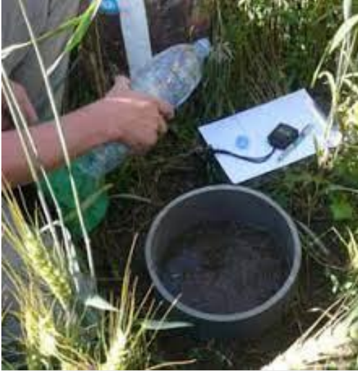
Figure 2 : Test Beerkan pour évaluer la capacité d'infiltration de l'eau dans le sol (Source : ITAB Asso)
