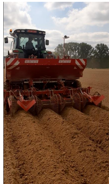
Figure 52 : Chisel utilisé pour reprendre les buttes, Figure 53: Passage de planteuse dans les buttes et Figure 54 : Buttes après plantation
