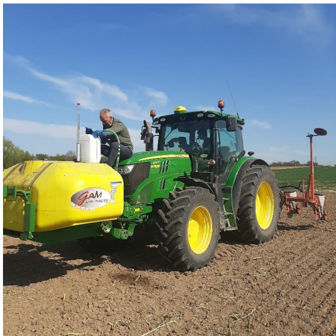
Figure 103 : Dispositif de fertilisation liquide pour le semis
