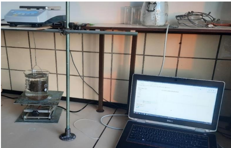
Figure 3. QuantiSlakeTest pour évaluer la stabilité structurale du sol
