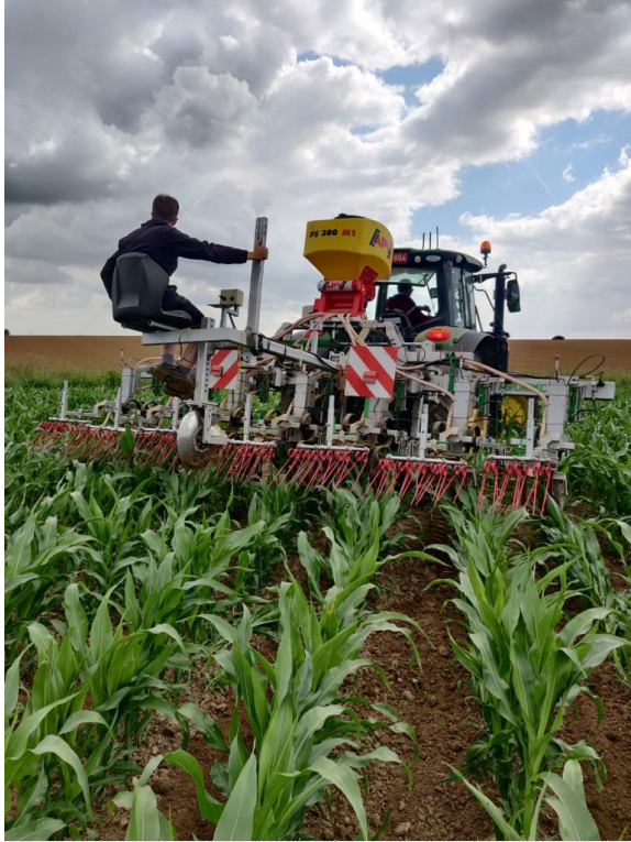
Figure 12 : photos du 13 juin lors du passage de la désherbineuse couplé au semis des petites semences
